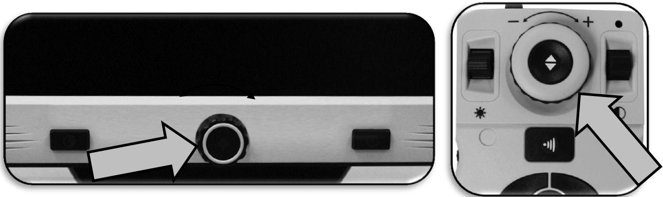
Abbildung 10 Zoom-Räder auf der Vorderseite und Bedienkonsole
