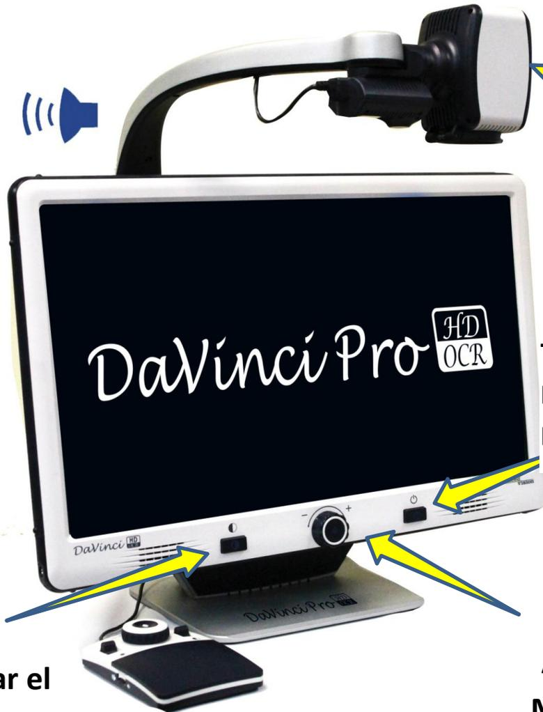
Cabezal de la cámara giratoria para cambiar la visualización del objetivo
